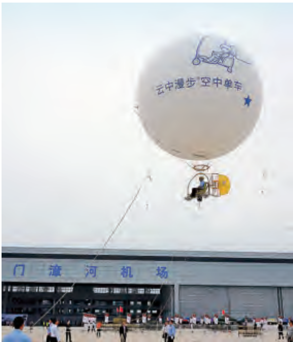
▲ 航空工业设计制造的“云中漫步”空中单车正式亮相。这是一款面向大众娱乐的低空骑行气球，可在50米升空高度范围内独自进行空中骑行体验
