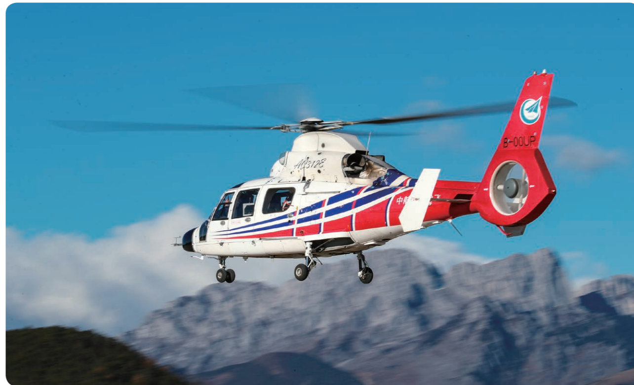
▲12 月 31 日，由航空工业哈飞自主研发的 AC312E 型直升机获得中国民用航空局颁发的型号合格证。该型机是在 H425 型机基础上的改进升级，计划 2020 年交付用户。
